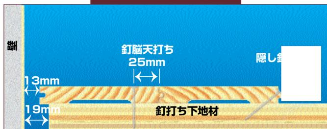
スターターストリップはさねの側から25mm 入ったところに脳天打ちで釘付けし、壁の部分には13mm の隙間を設けて、季節によるフローリングの膨張に備えます。2-3列このように敷いた後、パワーネーラーでさねの部分に隠し釘打ちをして行きます。
