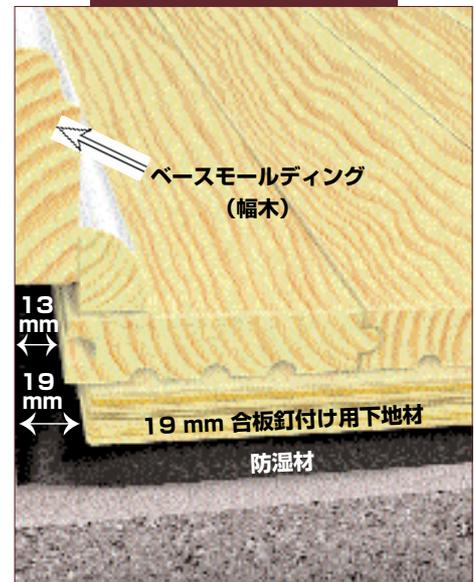
図6: コンクリートスラブの上に張られた合板の釘付け用下地材
