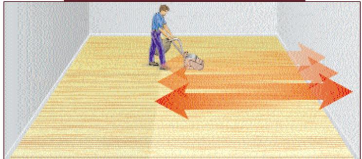
上: サンドがけはフローリングの方向と同じ方向で行ないます。部屋の長い方の右、幅の3分の2の部分から始めます。前向きで行って、後ろ向きに戻ります。次に、機械を左へ100mm程動かして、前向きにサンドがけします。
