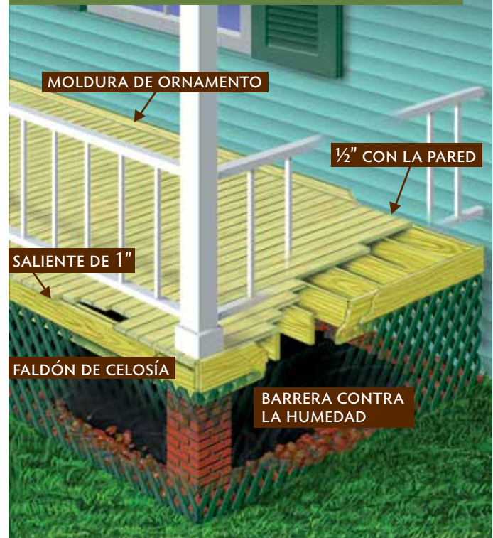
Figura 3: Consideraciones de diseño del pórtico
